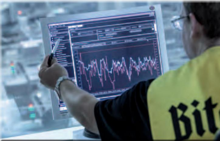
Das Modul Line Monitoring erfasst Betriebsdaten aus Abfüll- und Verpackungsanlagen und wertet sie aus. Grafische Darstellungen helfen, das Verhalten der Linien und eventuelle Störquellen zügig zu erkennen.
